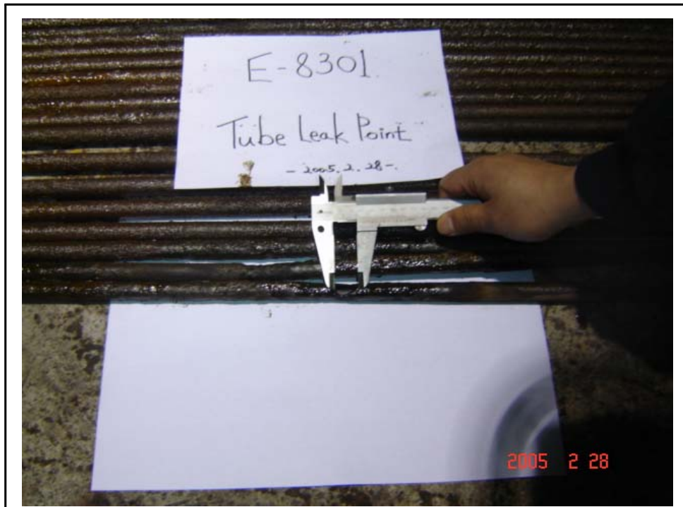
사진 4-7 E-8301의 Tube의 파열된 크기(약20×11mm 타원형)
